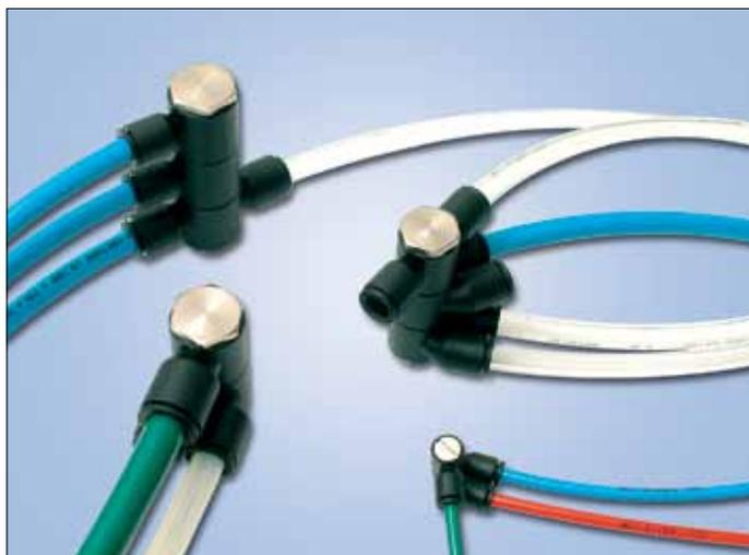
Os racores múltiplos modulares LF 3000 são obtidos por empilhamento de 2 ou 3 corpos de banjo sobre um parafuso para banjo; assim o número de saídas LF 3000 obtidas em um racor múltiplo modular pode variar de 2 a 6. As saídas LF 3000 podem ser para tubos de mesmo diâmetro ou diâmetros diferentes em um mesmo racor múltiplo modular.
