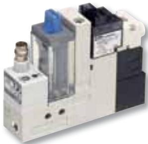
Compacto e leve, ótimo para processos de automação de alta velocidade. A Série MC2 integra uma válvula solenóide para gerar o vácuo e outra para liberação rápida da carga. Dispõe de uma válvula que possibilita controlar a expulsão da carga e conta, ainda, com filtro e silenciador.
