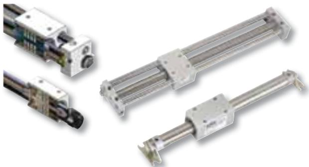
Com a Série de cilindros P1Z é possível obter movimento linear através de um acoplamento magnético entre o carro e o êmbolo, que se desloca devido a pressão pneumática.
