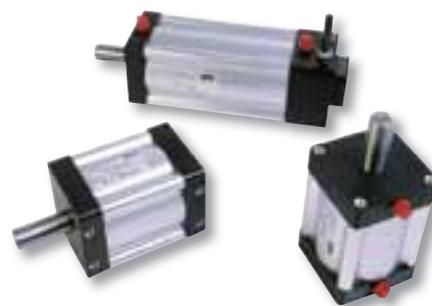
Os atuadores da Série PV incorporam características que proporcionam milhões de ciclos de operação livres de manutenção. A fabricação em alumínio anodizado e aço inoxidável permite a operação em ambientes agressivos, tais como os da indústria de alimentos e da química. Amortecedores podem reduzir choques e ruídos, permitindo taxas de ciclos mais rápidas. A posição angular pode ser controlada tanto com reguladores de curso como batentes internos.
