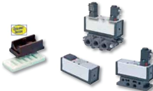
Além de atender à Norma ISO 5599-1, destacam-se como vantagens o sistema Non-lube, corpo de poliamida e o assento em cerâmica que garante até 100 milhões de operações livre de manutenção.
