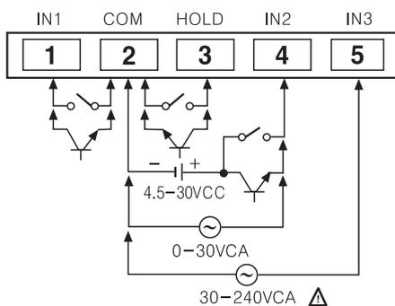
※ Use contatos confiáveis para comutar 5 μA de corrente quando for utilizar entrada de contato seco para sinal de pulso e reset.
