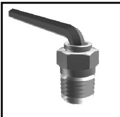
Todos os conectores macho tipo reto possuem um sextavado interno para uso com chave Allen, permitindo que a conexão seja montada em qualquer posição. Permite também montagens compactas onde uma chave fixa não pode ser usada.
