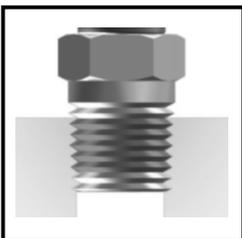
Todas as rosca macho cônicas são revestidas com um composto especial à base de PTFE denominado Loctite Vibra Seal 516, proporcionando uma perfeita vedação, redução do tempo de montagem, bem como dos custos de mão-de-obra. Elimina o uso de pastas ou fitas que podem contaminar o sistema.
