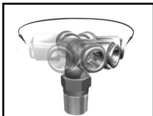
A linha de conexões Push-in® P da Detroit, possui tees e cotovelos com roscas machos orientáveis que permitem girar a conexão 360° para a instalação em lugares de difícil acesso e para posicionamentos precisos. Um anel de Buna-N garante a vedação entre o corpo da conexão e o plug roscado.
