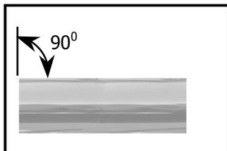
**1.** Corte o tubo perpendicularmente (tolerância de  $\pm 7^\circ$ ), tomando o cuidado para não danificá-lo externamente. O tubo deve estar livre de rebarbas.
