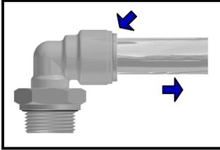
**3.** Para desconectar primeiramente libere o ar do sistema, então pressione a luva na direção da conexão e puxe o tubo, mantendo a luva pressionada.
