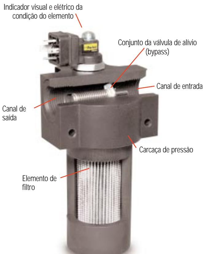
Os conceitos básicos para a escolha da carcaça do filtro inclui métodos de montagem, opções de conexões, opções de indicadores e pressão de trabalho. Todos, com exceção da pressão de trabalho, dependem do design do sistema físico e as preferências do projetista. A pressão de trabalho da carcaça é bem menos arbitrária. Pode ser determinada antes da escolha do tipo de carcaça.
