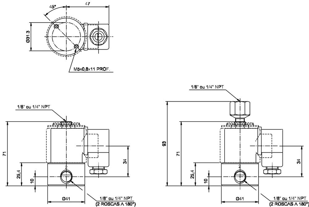
▷ Caixa à prova de explosão, água e pó, mostrada em desenho tracejado.
